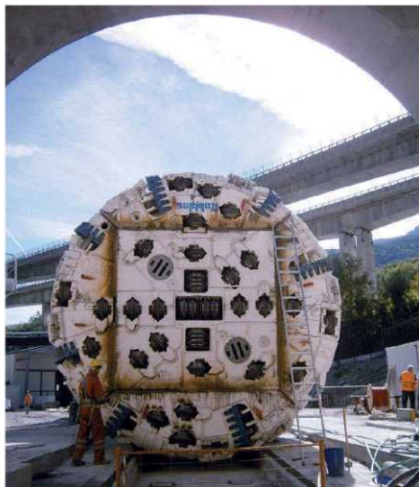
La fresa o "talpa" impiegata per sbriciolare la roccia
